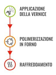
La bilancina, dopo essere stata caricata dei pezzi da trattare, viene verniciata nella cabina di verniciatura posta su una piattaforma traslabile. Le pistole elettrostatiche applicheranno la vernice in polvere ricoprendo tutti i manufatti. Se i pezzi da trattare hanno forme con sottosquadro sarà necessario l'intervento di un operatore per il ritocco.
